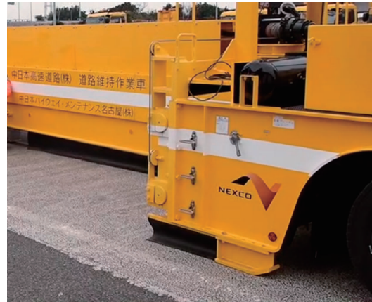
「作業時：アウトリガーを着地させた状態」
