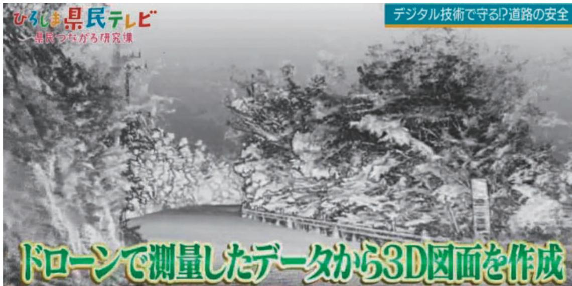
図 6.1 ドローン測量による 3D 図面を用いた法面崩落予測
