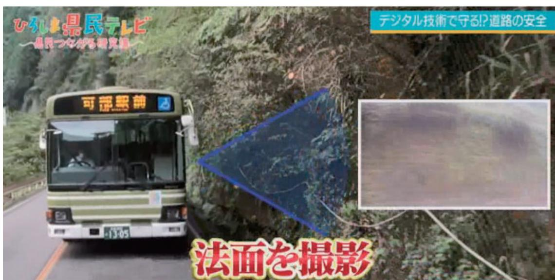
図 6.2 路線バスの車載カメラを用いた法面崩落予測
