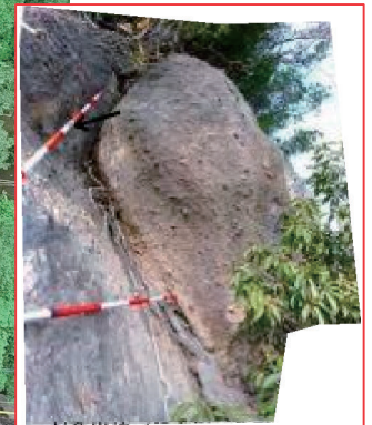
高さ約 15m 付近の縦約 3m、横約 2m、奥行き約 1m の不安定な岩塊。
