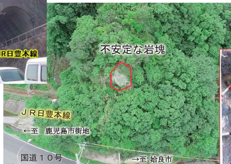
高さ約 15m 付近の縦約 3m、横約 2m、奥行き約 1m の不安定な岩塊。
