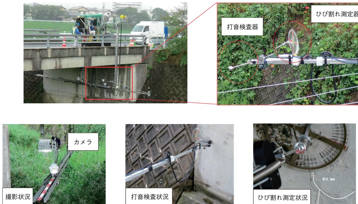
写真-3 点検ロボット『見る・診る』
