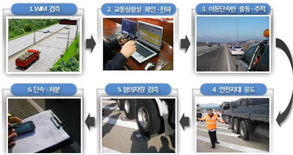
図-5 高速軸重器を用いた取締の実証実験
