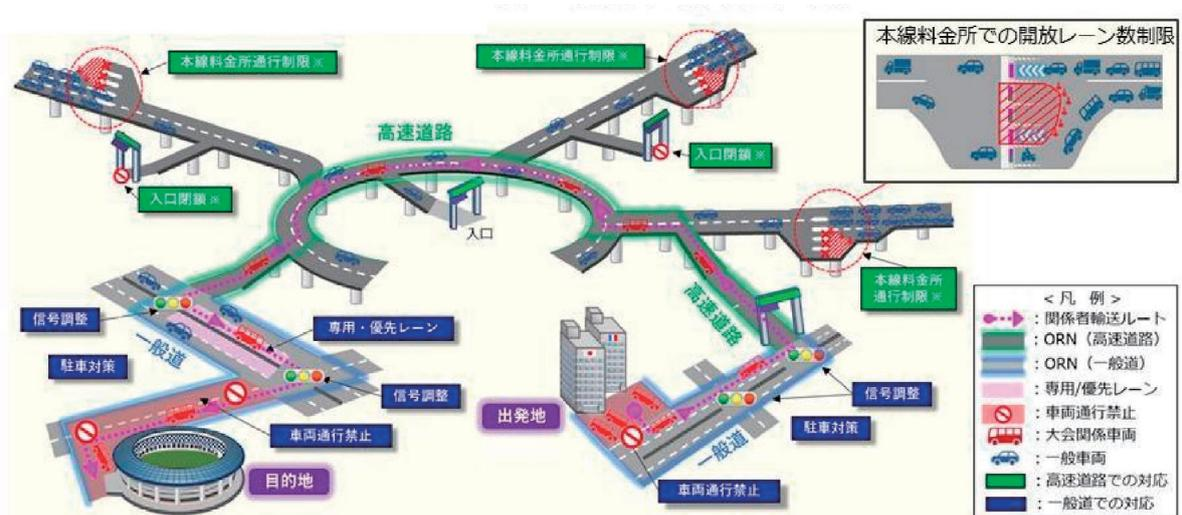
図2 TSMによる交通集中緩和のイメージ
