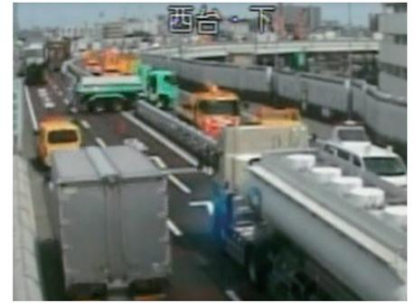
写真8 中央分離帯の開口部を用いた滞留車両の排出状況
