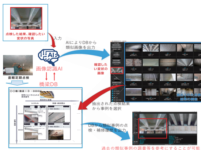
図-6 点検 DB を活用した画像認識 AI による直轄橋梁の類似事例検出
