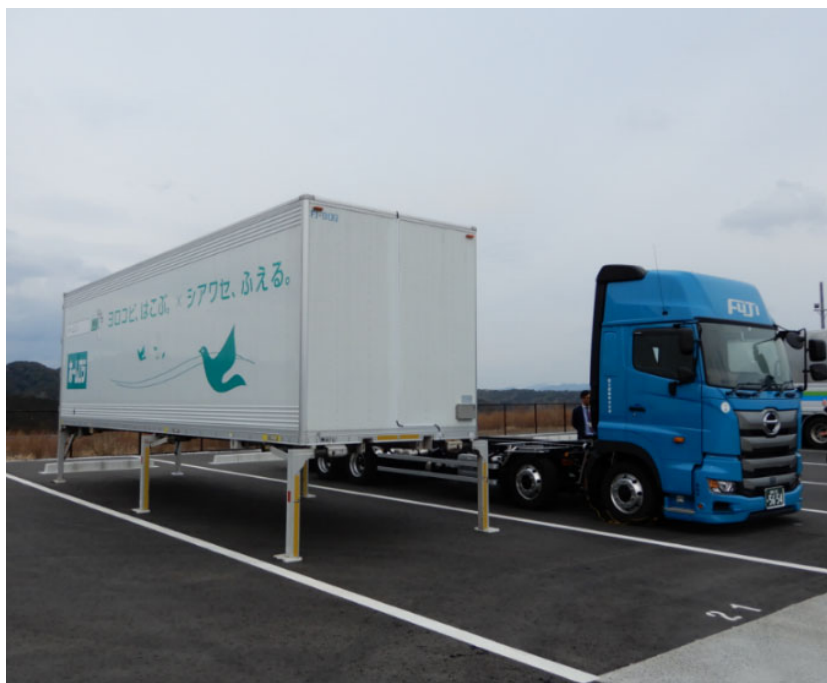
図 スワップボディ車両交換状況
