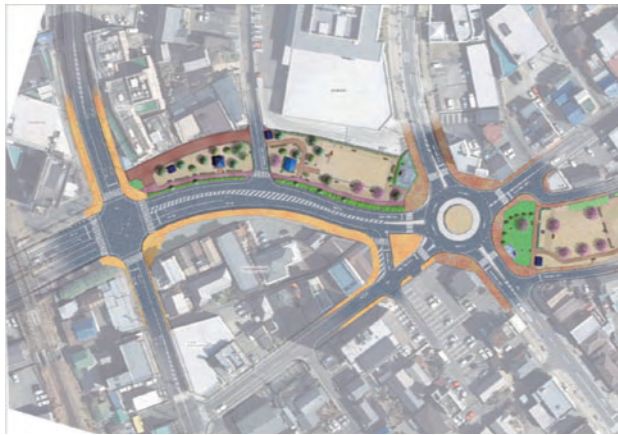
図9 日本で初めて信号交差点からラウンドアバウトに改良される飯田市東和町交差点の完成イメージ図 (資料提供：飯田市)
