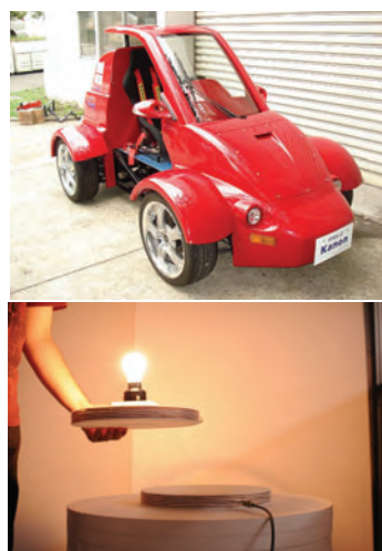
図19 超小型電気自動車（上）とワイヤレス電力伝送システム（下）
