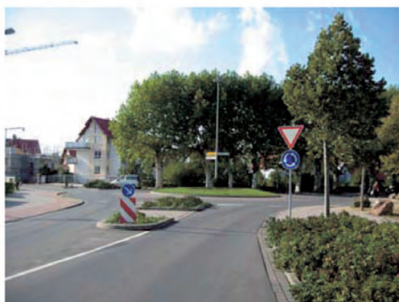
図5 市街地におけるコンパクト・ラウンドアバウトの例 (ドイツ・Dieburg)
