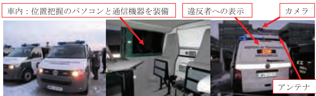
図3 モバイル型課金チェック (パトロールカー) (写真撮影 HIDO)
