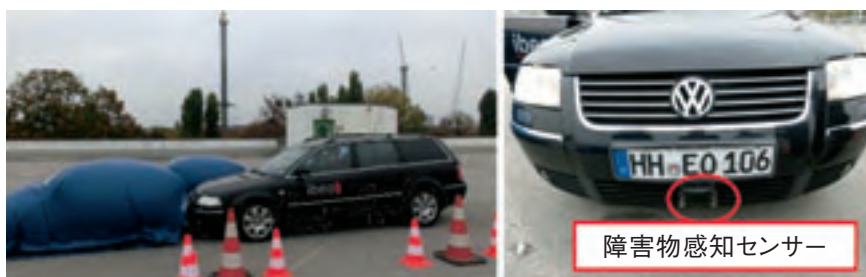
写真 13 衝突防止の車両
