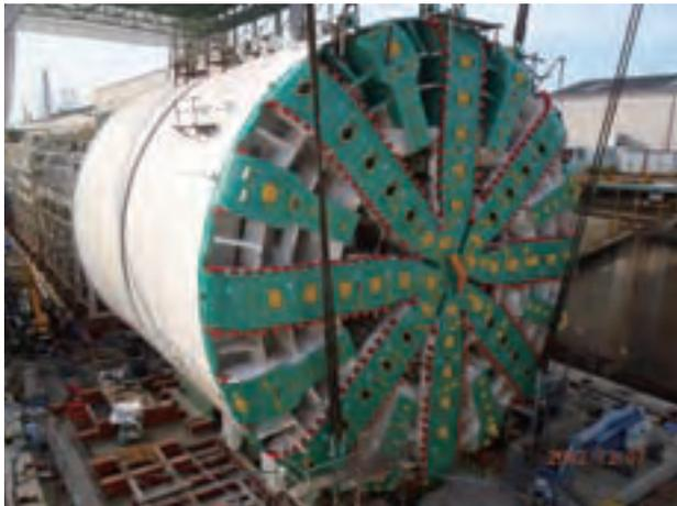
写真1 SR 99 トンネルで使用される TBM
