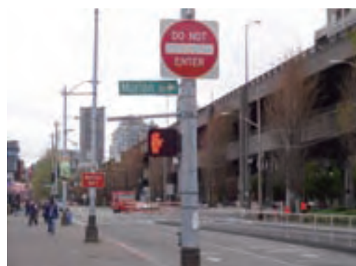
写真14 ダブルの誤進入対策標識
