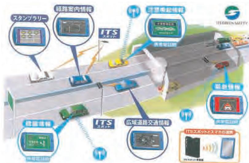
図4 モバイル通信とITSスポットの協調サービス (I2V)
