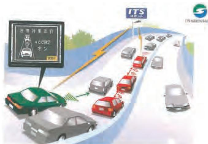
図3 高速道路サグ部の交通円滑化サービス (I2V、V2V)
