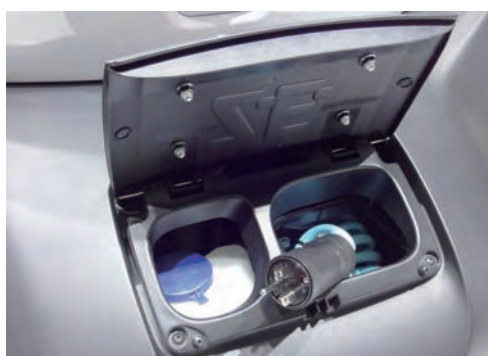
前面に配置された AC 充電コンセント
