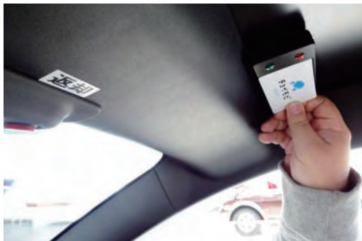
IC カードを車両のカードリーダーにかざして認証を行う
