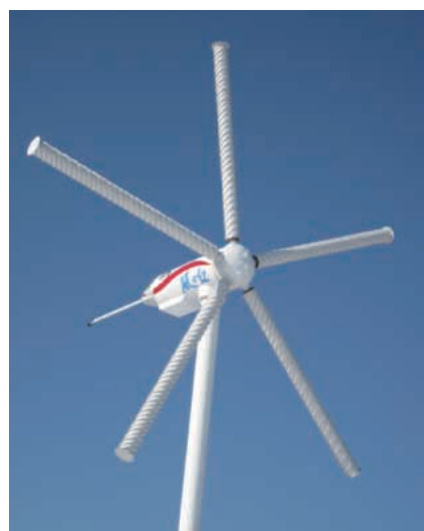
遠野風の丘シンボル「スパイラルマグナス風車」 (次世代型の風力発電装置 風車直径 11.5m、発電出力 19kw、 タワー高さ 12.5m)
