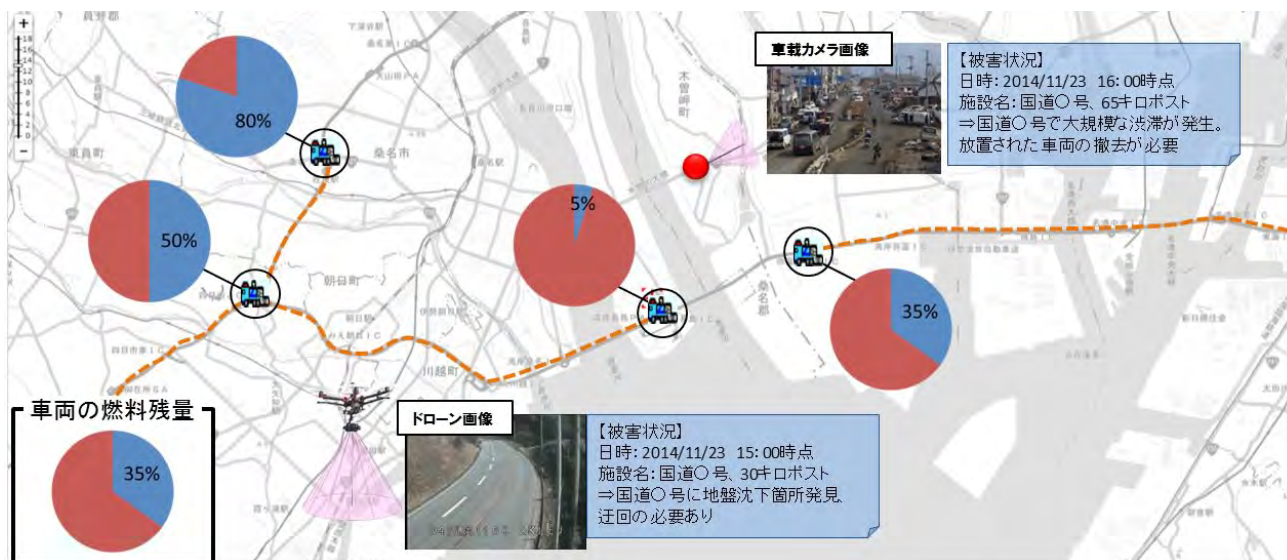
図4 プローブデータやドローン等活用による効率的な燃料供給システムイメージ
