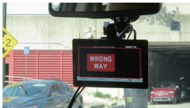
図12 逆走対策情報（逆走警報）表示
