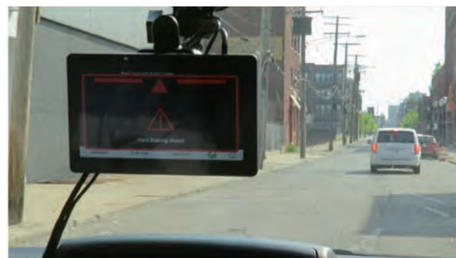
図8 前方車両急ブレーキ情報表示
