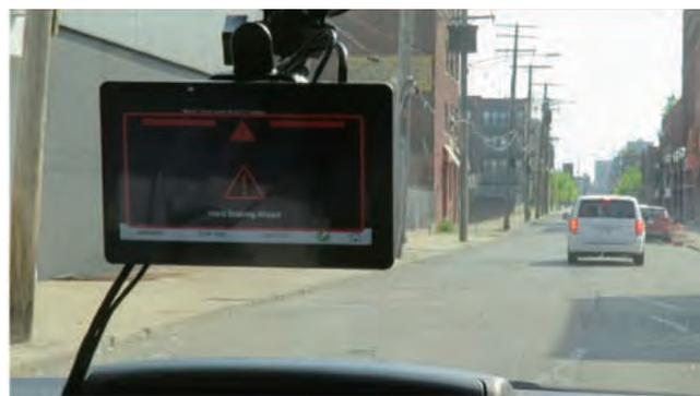
図8 前方車両急ブレーキ情報表示
