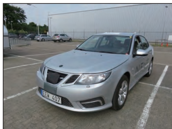
図 15 GPSのみの自動運転車両
