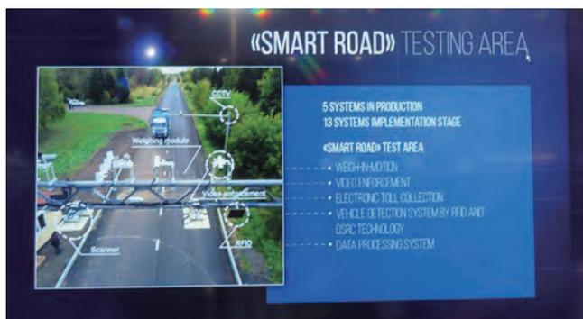
図7 過積載取り締まり設備の事例
