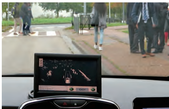
図 18 LiDAR による車線や人の感知
