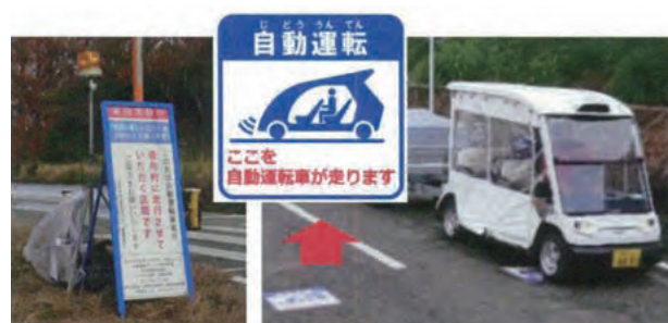
▲回転灯・看板の設置⇒路面標示の設置（みやま）
