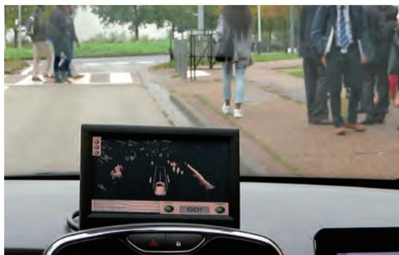
図 18 LiDAR による車線や人の感知
