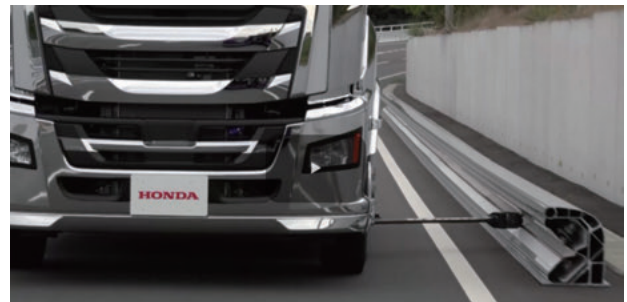
ホンダ方式の電気道路システム（HPよりキャプチャ）
