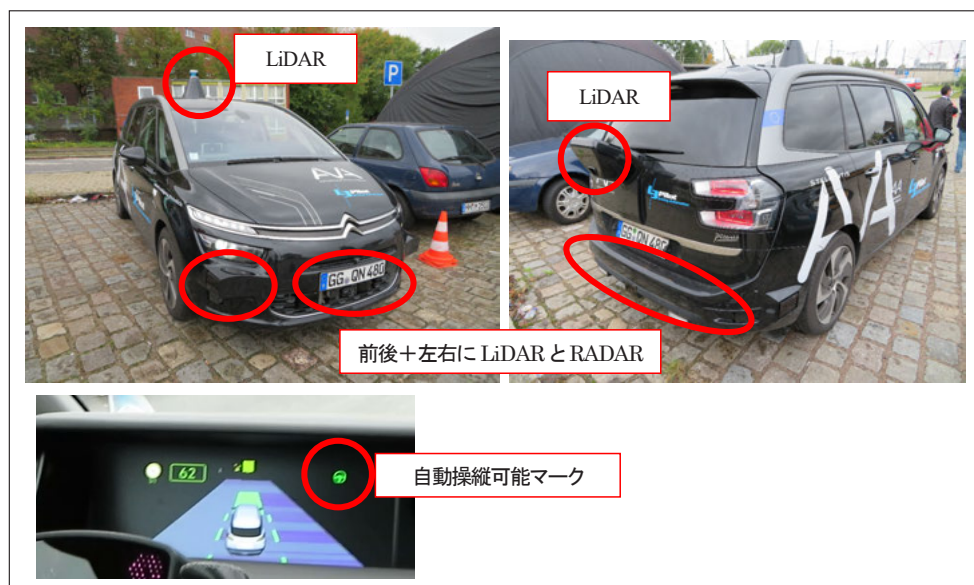
写真 8 高速道路自動運転 (L3Pilot)
