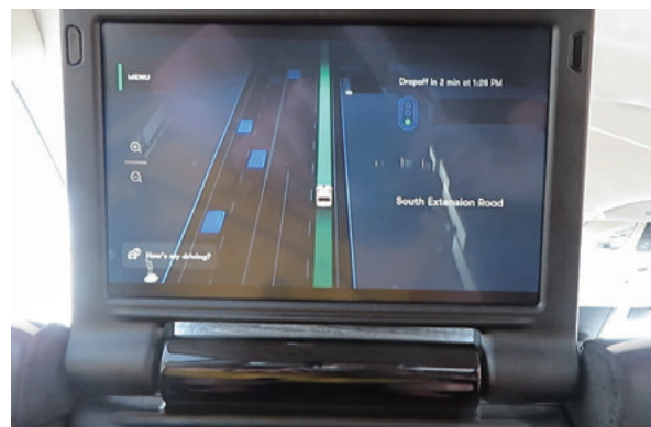
図8 LiDARで周りの状況を把握し、信号機から信号情報を入手して画面に表示
