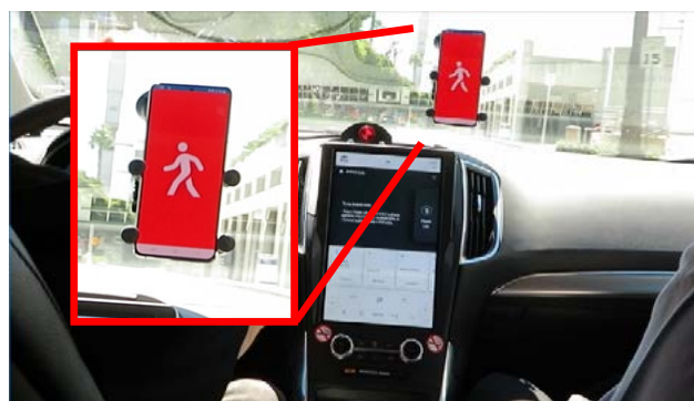
写真 20 注意喚起情報提供の例（左：作業者接近注意、右：歩行者接近注意）
