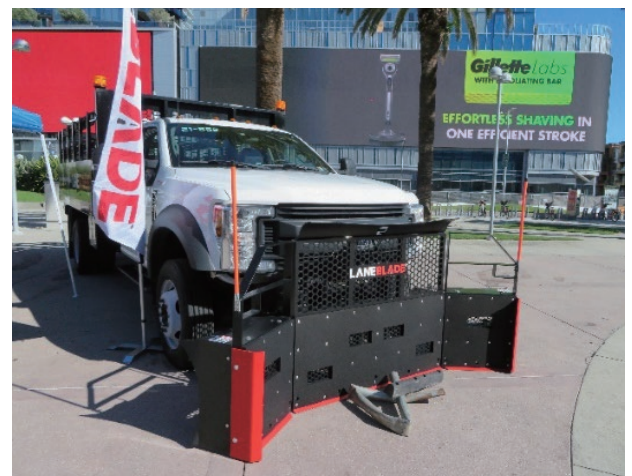
写真 12 道路上の障害物を除去する車両
