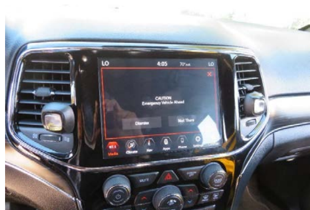
写真 14 セルラーを利用した緊急車両接近注意情報
