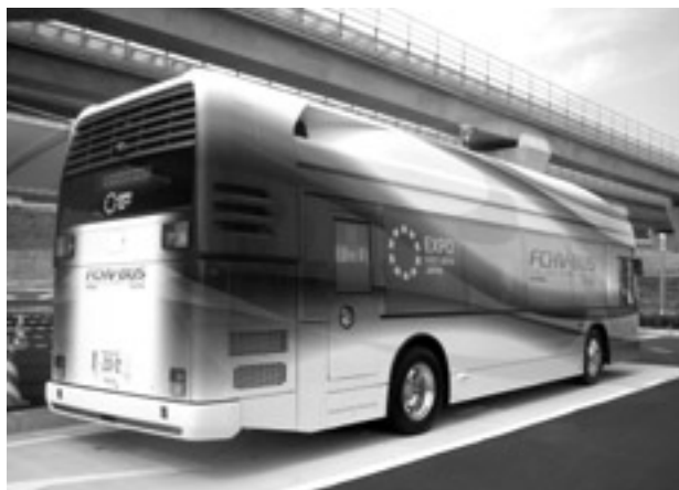
長久手、瀬戸両会場を結ぶ燃料電池ハイブリッドバス「FCHV-BUS」。ルーフ後部に高圧水素タンク7本を搭載、水素約30kgを充填する。
