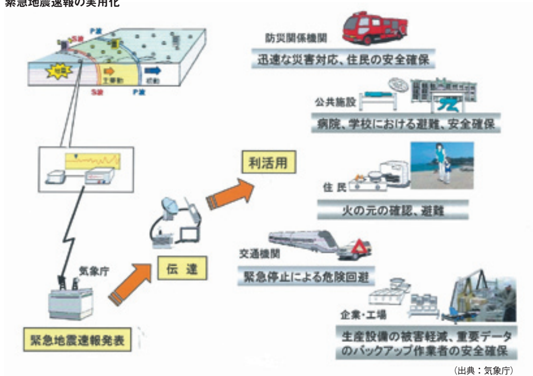
図 2. 緊急地震速報の実用化
