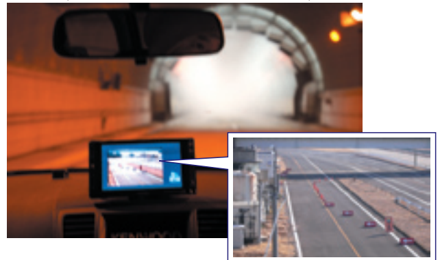
写真2 静止画の蓄積再生による情報提供 (トンネル出口先の工事車線規制情報)
