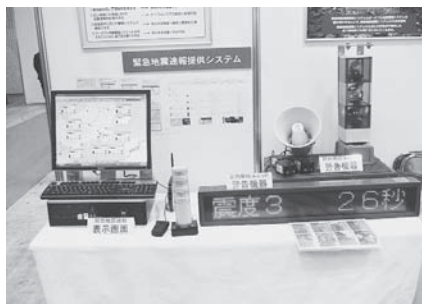
写真5 緊急地震速報提供システム
