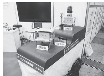
写真6 ポータブル地震警報システム (設置時)
