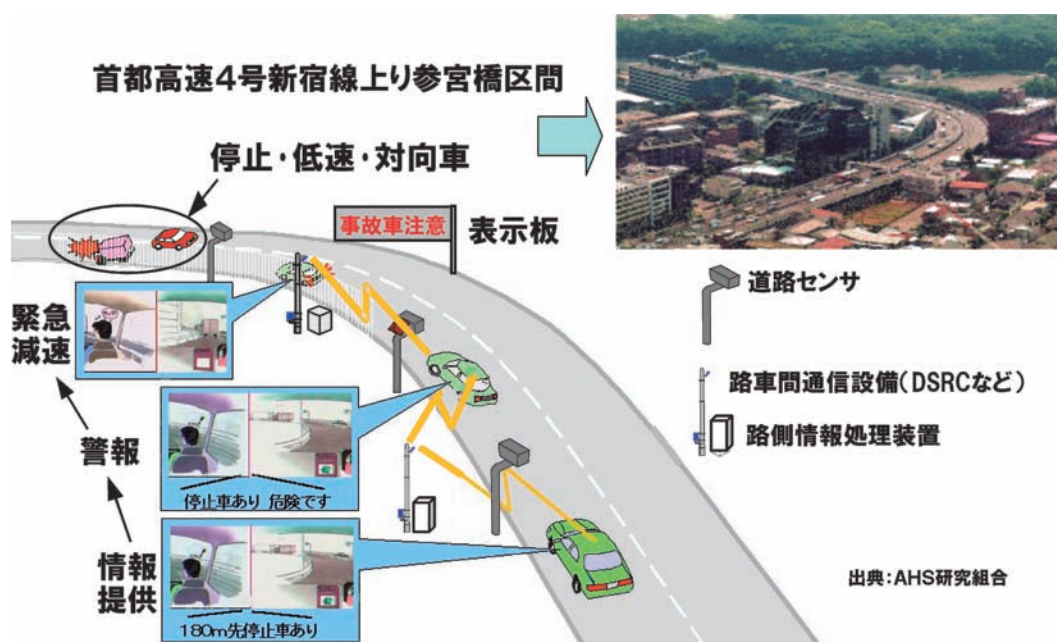
図1 前方障害物情報提供サービス
