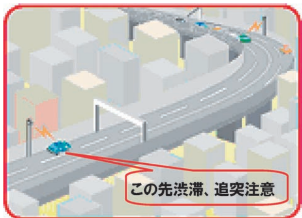
図8 音声による安全運転支援情報提供サービス（前方障害物情報提供）のイメージ
