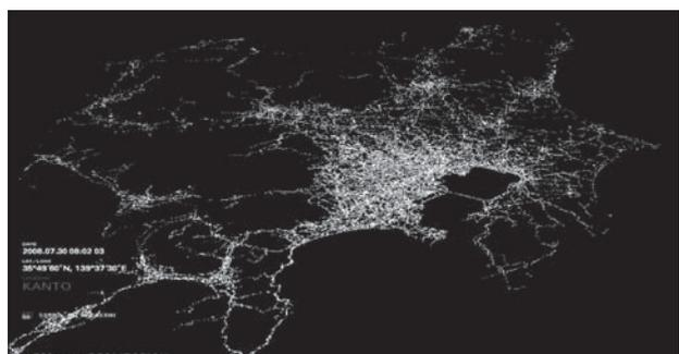
図3 フローティングカーデータ(FCD)の可視化
