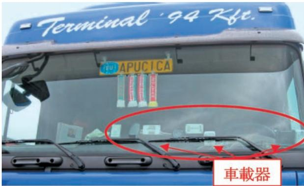
図1 車載器設置例
