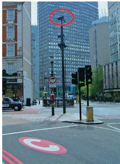
図3 ナンバープレート読み取りカメラ
