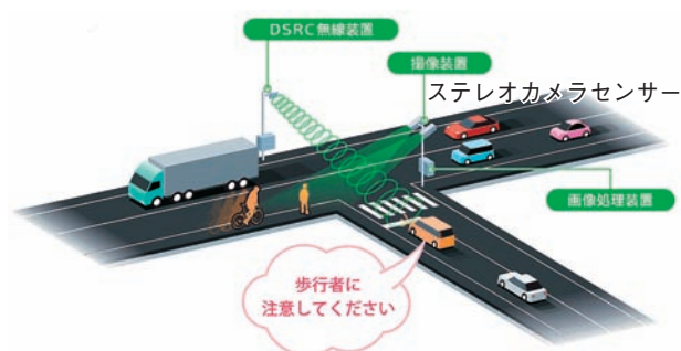
図2 ステレオ画像センサーを用いた左折時衝突防止システム
