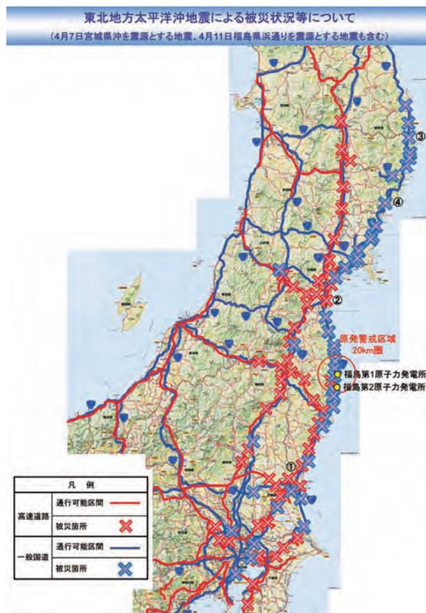
が各所で発生し、橋梁構造物に関しては、落橋・倒壊等大規模な損傷はなかったものの、支承やジョイント部の損傷が多数の橋梁で発生した。直轄国道は、津波により、太平洋沿岸の国道45号において、5橋梁の橋桁が流出した。（気仙大橋、沼田跨線橋、歌津大橋、小泉大橋、水尻橋）このほか、国道45号、国道6号において広範囲に冠水、ガレキ等の堆積が発生。国道51号、国道357号等でも路面段差、ジョイント損傷などが発生。地方自治体管理道路でも津波等により、太平洋岸各地において、12橋梁が落橋及び流出。また、段差、亀裂、小規模崩壊等の被災は極めて多数発生した。
