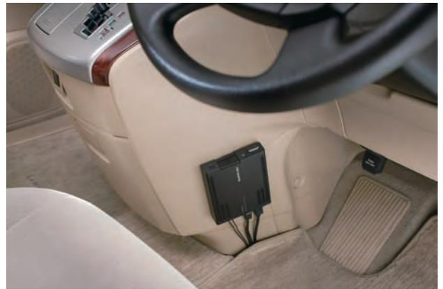
図4 AVIC-VH09CS に付属のクルーズスカウターユニットと取り付け例
