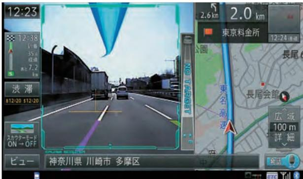
図5 ARスカウターモードの機能例
