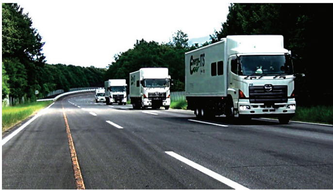
図 2013 年 エネルギー ITS 推進事業による大型トラックの自動運転・隊列走行実験 出典 NEDO (Source NEDO) Figure Automated heavy-duty truck operation/platoon tests of Energy ITS Project 2013
