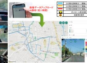
車載装置による路面性状測定
