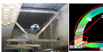
3次元レーダースキャナを用いてトンネルの変位・変形等を3次元モデルで可視化
