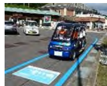
路上駐車対策 (走行位置の明示)
