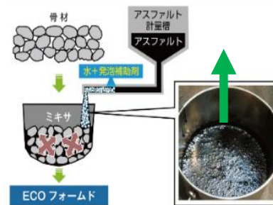
アスファルトの中温化技術
