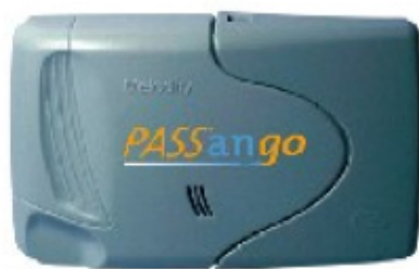
図 1-4-8 重量貨物車向け車載器
