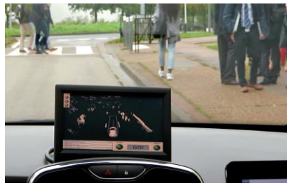
図 12 LiDAR による車線や人の感知
