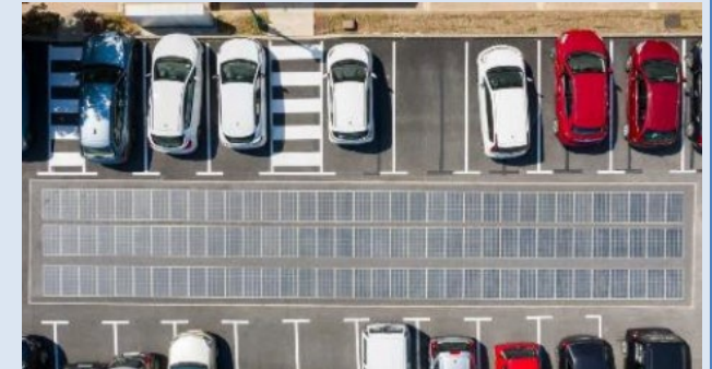
駐車場路面の太陽光発電舗装
