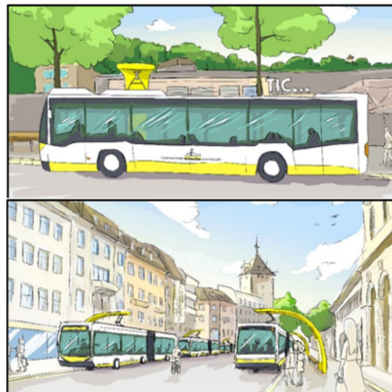
急速充電システムを備えたeバス（架電線なし）
