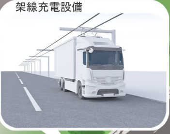
架線充電設備
