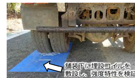
実験施設での強度検証
