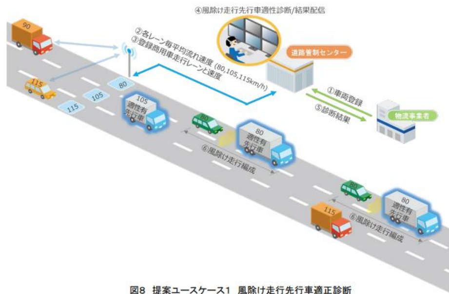
図8 提案ユースケース1 風除け走行先行車適正診断
