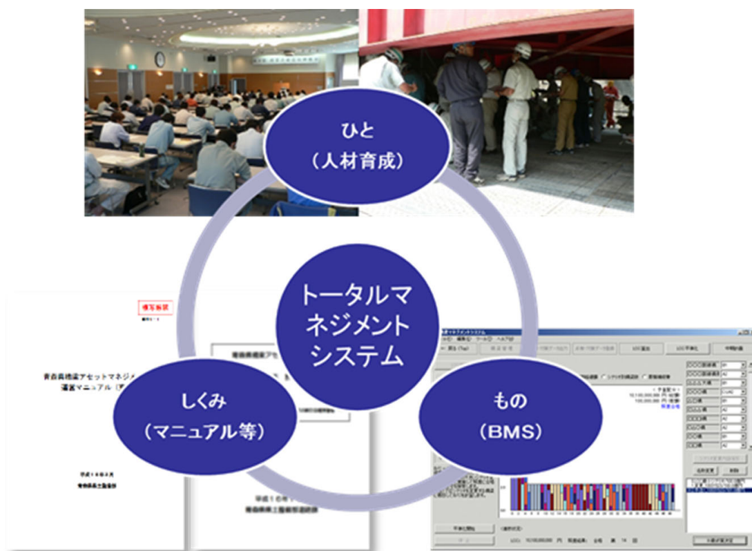
図ー1 青森県橋梁アセットマネジメントシステムの構成
